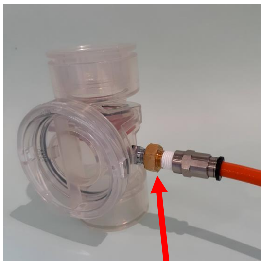
①検査器のエア挿入ホースを 加圧挿入口に接続 検査開始
